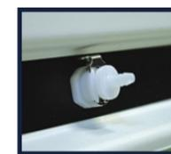
可使用彩色束管在检测端口对出风口的空气抽样来检测过滤器饱和状况。
