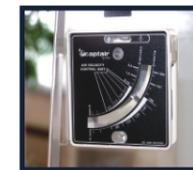
显示操作口面风速的参考值。如果面风速长期处于较低值，意味着H 14或前置过滤器阻塞，或者风机系统故障。
