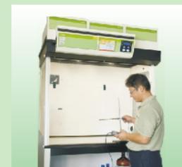
我们的售后服务工程师配备有专业的检测设备，根据安全的要求来检验每一个项目，并完成过滤器的更换及新过滤器的检测。
