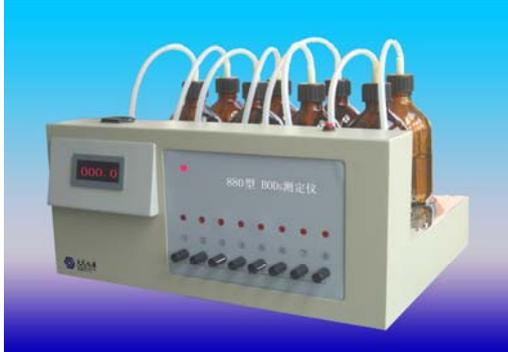
880 型数字式BOD<sub>5</sub>测定仪采用空气压差法原理设计而成，当被测样品在  $20 \pm 1^\circ\text{C}$  条件下恒温进行五日培养后，经过生物氧化作用，有机物转变成氮、碳和硫的氧化物，并产生二氧化碳气体被氢氧化钠吸收，培养瓶内压力减少，通过压力传感器将变化量转为电信号，从而可以检测出被测样品BOD<sub>5</sub>的值。
