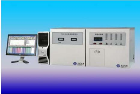
TN-3000 型硫氮测定仪采用氧化燃烧和化学发光法测定样品中的氮含量。测定过程通过计算机进行控制和处理，性能稳定可靠、分析精度高、重复性好、操作方便灵活，可替代进口。通过增加 TS-3000 型硫含量检测模块可升级为 TSN-3000 型硫氮测定仪，对样品中的硫和氮同时进行检测。
