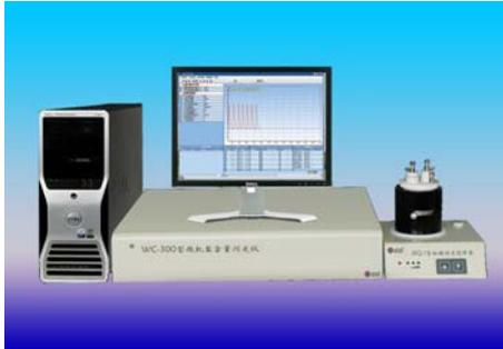
WC-300 型微机盐含量测定仪是应用微库仑分析技术，采用计算机控制微库仑滴定的最新产品，具有性能可靠、操作简易、稳定性好、便于安装等特点，适用于原油及其产品的盐含量的测定。仪器亦可用于重油、渣油、工业废水及生活污水中的盐含量的测定，同时还适用于上述各种样品中无机氯离子的测定，是当前电脱盐工艺控制盐含量的理想仪器。
