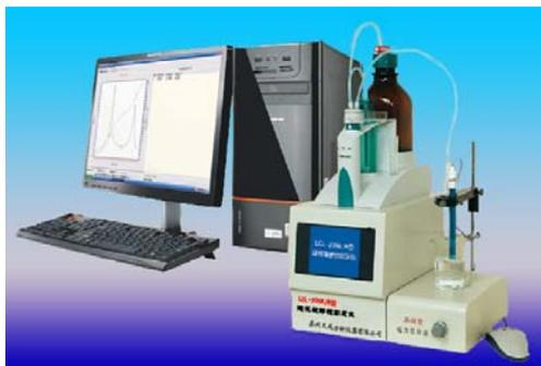
仪器采用电位滴定法测量油品中的硫醇硫含量。适用于石化行业测定无硫化氢的喷气燃料、汽油、煤油和轻柴油中的硫醇硫，硫醇硫的测定在评价喷气燃料、汽油、煤油和轻柴油的气味、对燃料系统橡胶部件的不良影响及对燃料系统的腐蚀具有重要意义。采用方便更换的进口一体化滴定交换单元，配置防渗透滴定头，滴定精度更高，整机可靠性好。
