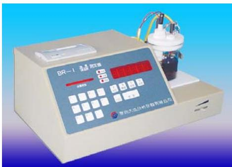
BR-1 溴价溴指数测定仪是根据微库仑原理，采用微型电子计算机控制测量和电解，并进行数据处理的智能仪器，微机对电解整个过程的电流进行时间积分，求出电生Br<sub>2</sub>所耗电量，根据法拉第电解定律，计算出样品的溴价、溴指数。
