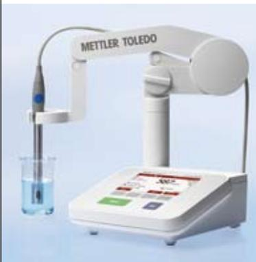
uPlace™：单手就能方便操作该电极支架，可完全垂直上下移动支架。这样能够更快速地测量，并避免样品容器的翻倒和避免电极损坏！
