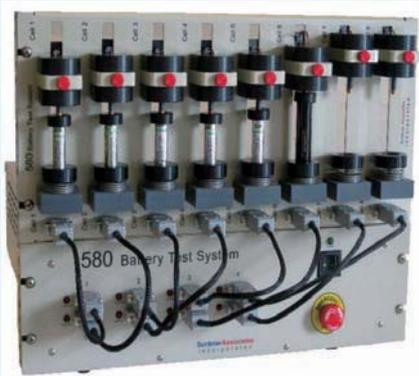
圆筒形电池测试装置
