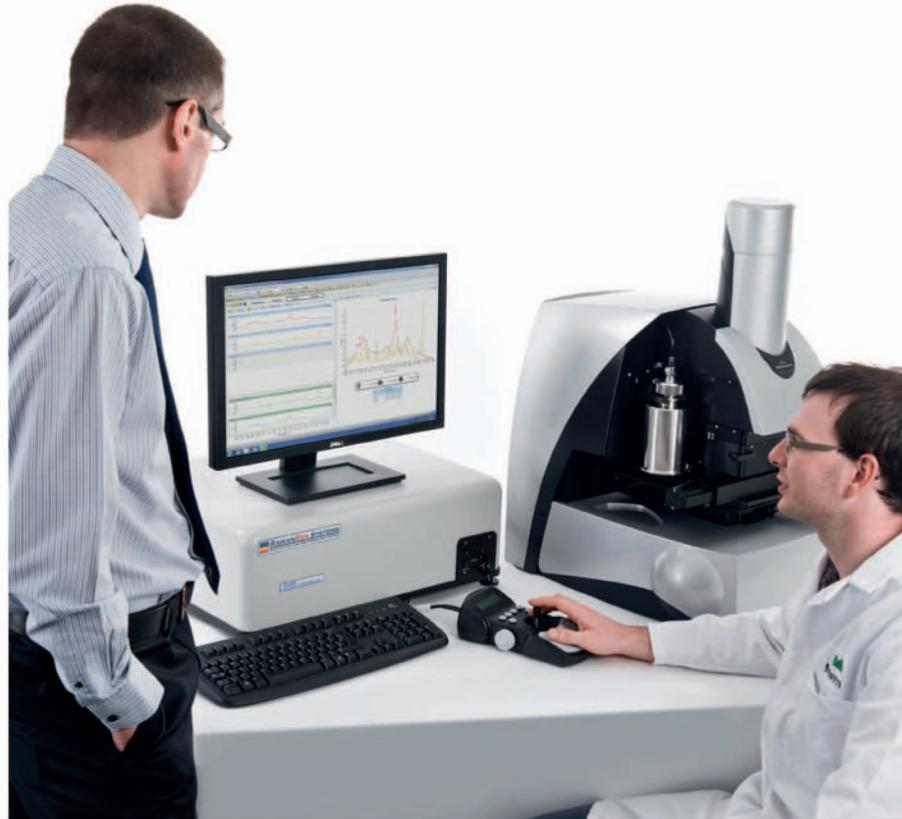
Morphologi G3-ID是一款将自动成像技术与拉曼光谱技术完美结合的分析仪器。通过使用自动成像技术，不但可以获得具有统计意义的颗粒尺寸及形状信息，而且使得每一个待测颗粒都得以“真实”再现。同时引入的拉曼光谱系统，使客户能够对样品中任何“所需”的颗粒进行拉曼光谱测试分析，从而获得相应颗粒的化学组分信息。全自动的仪器设计使得不论您是否具有丰富的颗粒表征及光谱学经验都可以通过该仪器对颗粒样品进行深入地了解。
