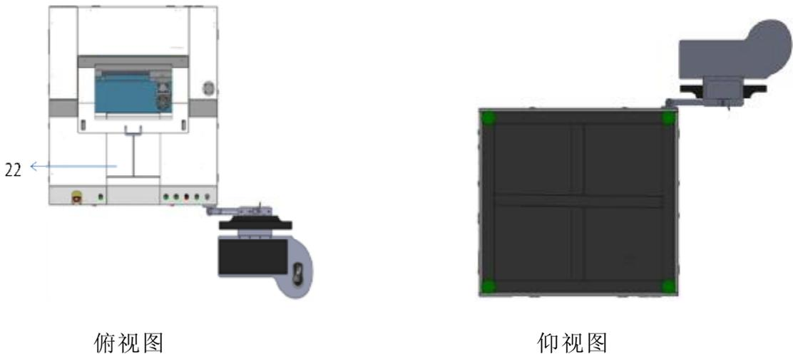
1. 工控机；2. 激光器面板观察窗；3. 机器型号；4. 按钮操作面板；5. 前上维护门；6. 显示器支架模块；7. 外部接口；8. 后下维护门；9. 花岗岩平台；10. 后上维护门；11. 机器铭牌；12. 后散热风扇；13. 气动系统维护门；14. 自动上下料模块接口；15. 左前维护门；16. 左后维护门；17. 散热风扇；18. 电控系统维护门；19. 自动上下料模块接口；20. 右后维护门；21. 右前维护门；22. 切割区开合门；
