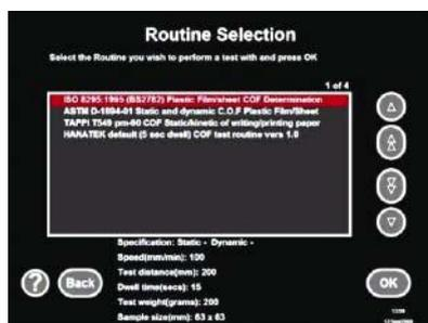
仪器有预装测试模式介绍, 以确保样品根据相关国际标准测试
