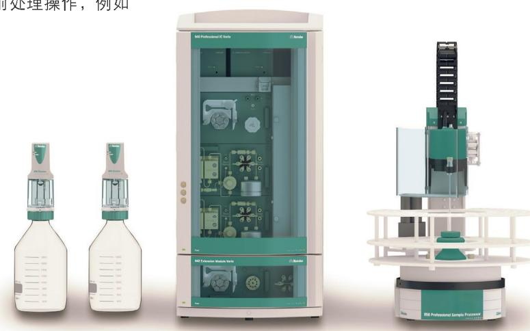
通过与942系列离子色谱功能拓展模块的灵活搭配，940系列谱峰思维™离子色谱可实现分析通路的升级和高压梯度的升级。例如，除了常规的阴-阳离子双通道系统外，通过系统升级，还可实现阴-阴离子双通道系统的升级。显然，这样的升级会使离子色谱的分析效率加倍。
