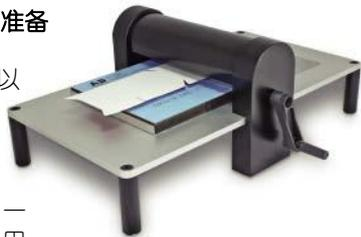
要测试的纸板和折痕样品可一次切割完成，因而避免了使用老式切刀进行样品准备可能带来的错误。
