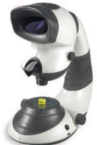
高稳定性的台式支架, 配有调焦距, 可调暗淡的底部照明。
