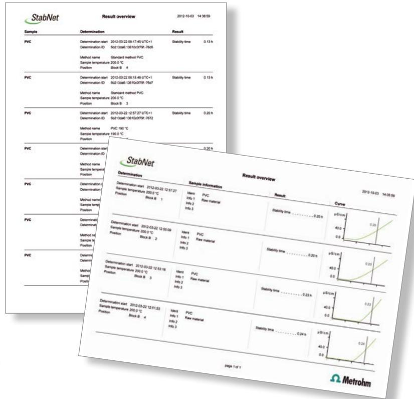
表格式报告（附带或无附带测量曲线）或图画格式，提供大数据量测量结果的一览表
