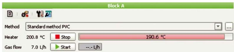
每一个加热模块，都有一个单独的方法，除其它参数外，可以设定不同的温度和气体流速。加热可以通过《Workplace》中的程序以人工方式启动；也可以用设定计时器的方式，自动启动加热功能。此时仪器已经准备好启动，来迎接一天的工作。
