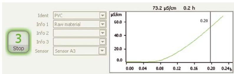
对于每一个测量池而言，在《Workplace》程序中有一个实时的显示屏。在显示屏中，Start/Stop按钮会闪烁，这意味着测量正在进行。从相应的实时曲线上可以直观地看到当前测量的运行状态和已经检测到的终点。可输入的关于样品的识别信息栏和其它信息栏共有4栏。重复使用的样品信息可以作为文字模版保存下来，以后可以很轻松地在《Workplace》上选择使用。
