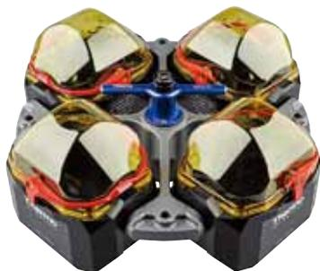
Thermo Scientific BIOFlex HC 转头可离心 40 x 50 mL 尖底管，或 96 x 15 mL 尖底管，或 24 块标准酶标板，多样的适配器可用于超过 35 种其他规格的离心容器
