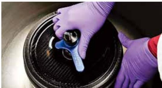
创新的速旋转头盖手柄，使得转头盖拧紧更方便，也便于（离心实验结束之后）开启转头盖
