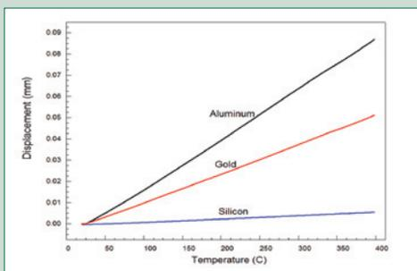
热膨胀系数 (CTE) 不匹配可能导致早期故障——从马达冻结到食品包装破裂，再到微型芯片上的焊接不良。这些 CTE 曲线所示为膨胀率与温度之间关系迥然不同的三种纯金属。
