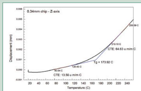
电子设备制造商和设计人员非常关注材料的热膨胀以及软化点和玻璃化转变。行业标准测试方法要求测量所有这些因数，如本例中 z 轴方向的芯片所示。
