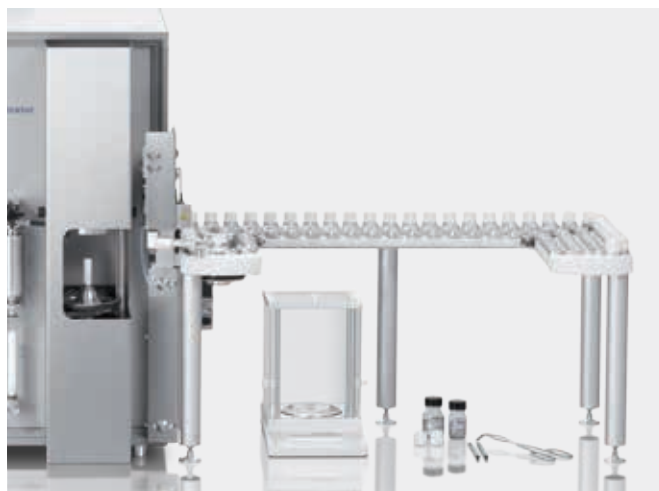
可装载130个样品的自动进样装置
