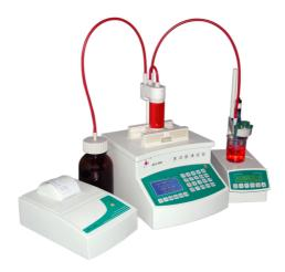
ZDJ-400 全自动电位滴定仪可进行酸碱滴定、氧化还原滴定、络合滴定、沉淀滴定和离子浓度测定等实验;具有动态滴定、等量滴定、终点滴定、PH 测量等多种测量模式;中文操作界面显示滴定过程,可进行中英文输入、输出;能够存储滴定方法,快速启动实验;动态显示滴定曲线;工作站既可以监控全部滴定过程、分析实验结果,也可以对滴定仪进行版本升级。
