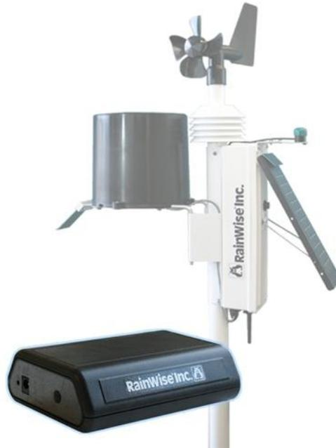
AgroMET 农业气象站是美国 RainWise 公司专门为农业环境所设计的一款无线自动气象站，用于记录风速、风向、温度、湿度、降雨量、叶面湿度和太阳辐射。气象数据从 AgroMET 气象站通过无线方式传输到 IP-100，然后传输到 RainwiseNet™网络，在整个传输过程中并不需要电脑，只需要一根网线连接到因特网中。其良好的耐用性和可靠性，使其应用于科学种植、农药喷洒及农业灌溉等领域。气象站测量的气象数据并不需要电脑，可以使用 IP-100 通过直接传输到云端服务器。
