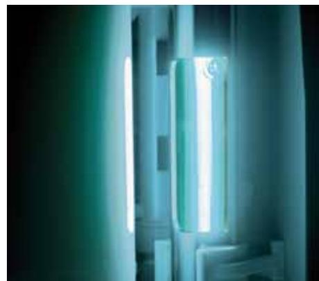
一个高性能的 UV 灯正常运行是超纯水中微生物和有机物达标的保证。高品质的 UV 灯一般应用石英玻璃，对于这个区域的波长有着低吸收率。它的外壳是耐腐蚀的 316L 不锈钢。
