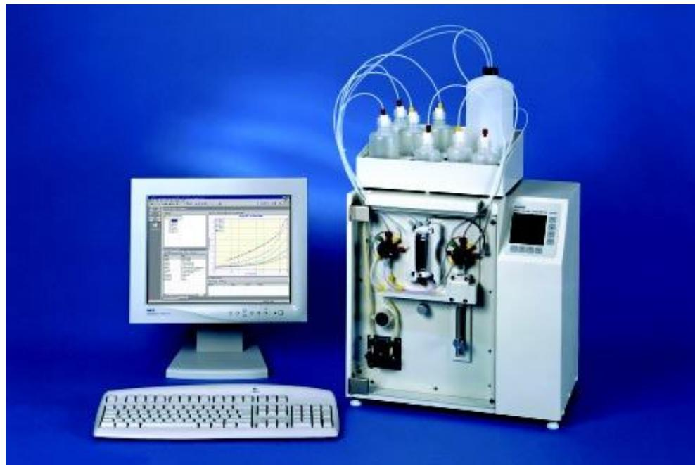
DVT30 是一款全自动测量界面张力的仪器。该仪器操作简单，进样速率和温度可以随意设定，使用特殊的精确毛细管。测量范围可达到  $100\text{mN/m} \sim 0.05\text{ mN /m}$ ，且无需对测定值进行校正。仪器具有自动循环清洗功能，易于维护。直接测量样品温度、保证数据的精确可靠。DVT30 所使用的精确毛细管，管壁的厚度非常薄，具有特殊的毛细管尖端，相比其他的具有平坦尖端的毛细管来说，不需要对测量得到结果进行校正，简化操作。毛细管尖端照明良好，整个测试过程易于观察。进样管、进样针和测量单元等独立部件更换简单，省时省力。
