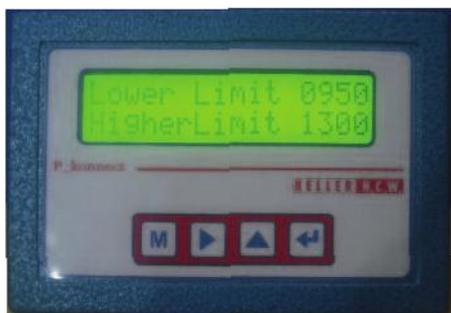
PD 830 可实现在控制站进行远程控制。用户可定义多达10个数据集，例如可设定10种不同合金的温度容限。
