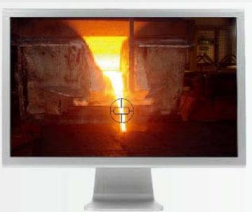
作为任选项，CellaTemp PA 83 可配有内置式摄像头。摄像头的感光度可自动根据矩形测量范围内捕捉到的实际目标物体的亮度进行调整。摄像头可提供目标点和周围环境的高对比度清晰图像，因而在控制室的监控器上即可观察到工艺过程。
