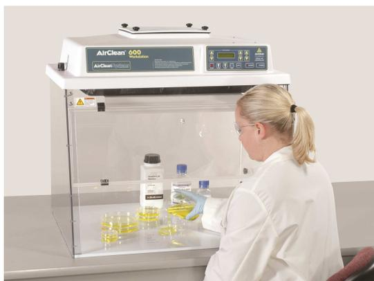
AirClean® 系统 AC600 系列垂直层流工作站, 是在实验对操作人员无害, 但又要求洁净空间时的理想应用, 其结构紧凑, 重量轻, 允许在一个实验室里有多个“清洁区”。
