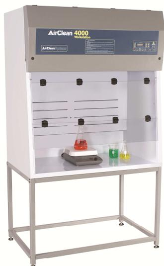
AirClean® 系统聚丙烯无管道通风柜能有效清除有毒微粒、化学烟雾或蒸气，保护操作人员和环境安全。使用腐蚀性物质时，其标准的隔热防溅漏托盘能显示出优良的耐化学性。能容纳 7 英寸的过滤器，HEPA 过滤器和活性炭过滤器可叠放。
