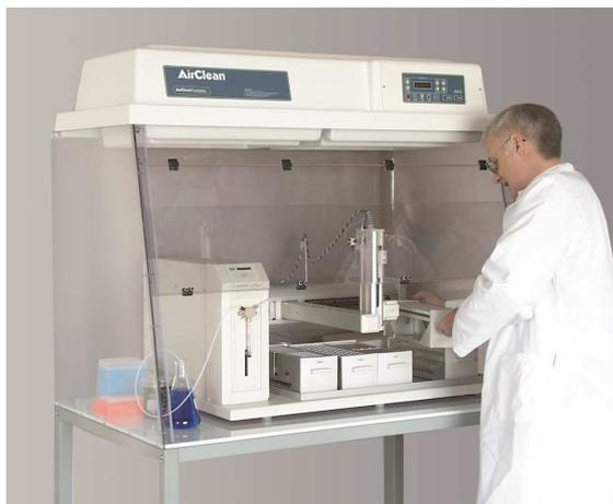
AirClean® 系统机器人安全通风柜是为操作人员免于受到烟雾、蒸气、微粒伤害而设计。采用 AirSafe™ 的自动安全控制器技术。也可以与 UVTect™ 微处理器控制器结合使用。
