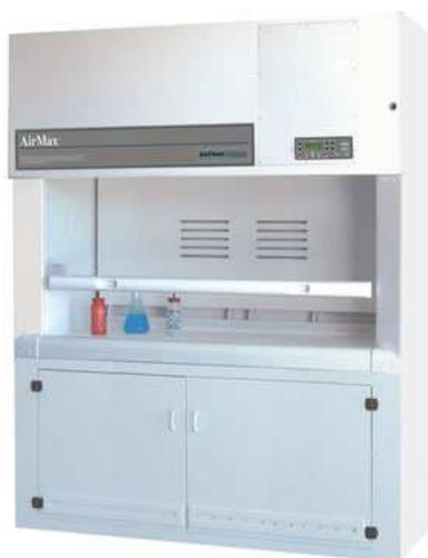
AirClean 系统公司的 AirMax™ 全排式通风柜由纯白结构型 PP 制成。采用无缝式设计，具有超凡的化学防腐性和抗生锈性。采用标准旁路设计，无论柜门开合大小，均能恒速排出气流。配有微机处理控制器监控柜门面气流速度，并在 LCD 屏实时显示，单位：inch/min。
