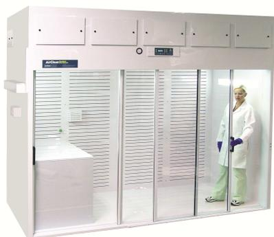
AirClean® 系统直立式无烟道通风柜为处于有烟雾、颗粒物释放的生产制造过程中的操作者提供有效防护。可选各种不同窗扇最大限度地保护操作者。
