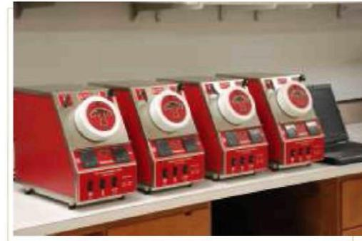
软件包最多可为四台Quantum®仪器提供自动化压力和温度监测以及测试终点检测。测试终点的标准可以按时间长度、压降或裂解水平加以选择。DAQ 通过使用USB连接设备所含的笔记本即可获得DAQ问题答案.....
