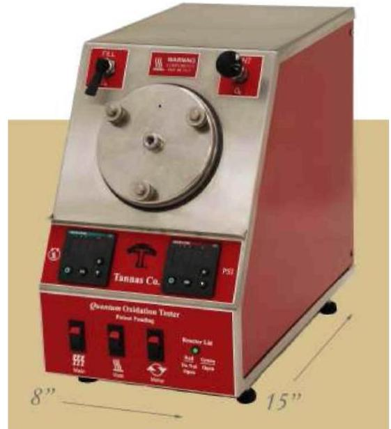
各种不同大小的热机油槽长期在本行业中用于进行旋转压力容器氧化测试或称RPVOT（曾被称作RBOT）和薄膜摄氧测试(TFOOT)。这种机油槽会让操作员暴露在热机油烟雾环境，并且很容易泄漏，需要定期维修，并且会很脏，在操作中存在危险。
