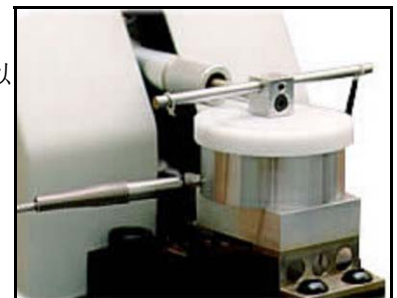
HFRR Situ内的汽油配套装置
