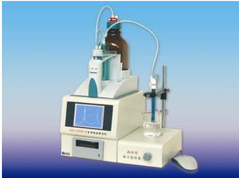
DDY-2008J 型自动电位滴定仪采用机电一体化结构设计，仪器完全由微电脑控制控制，实现滴定过程及数据处理自动化、可视化。选用不同的电极可进行：酸碱中和滴定、沉淀滴定、氧化还原滴定、络合滴定、非水滴定（如测定石化油品中碱性氮、硫醇硫、酸值、碱值）等多种滴定，滴定系统采用进口精密型特殊材料一体化交换单元，配置防渗透滴定头，耐高氯酸腐蚀，仪器更加可靠，使用寿命更长，适合多行业应用。
