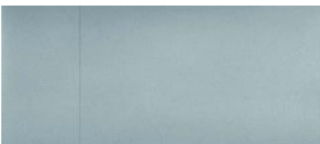
图 2. 存在可视行缺陷的显示屏屏幕的光学测量。 图 3. 行缺陷是由影像亮度色度计 AOI 软件识别的；屏幕上为用户指明了缺陷位置。
