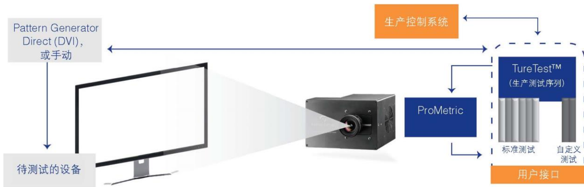
图 1. FPD AOI 测试设置，影像亮度色度计处在自动软件控制下。
