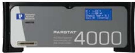
PARSTAT 4000是普林斯顿应用研究最新一款高端研究级电化学工作站系统，支持进行全面的电化学技术测试。
