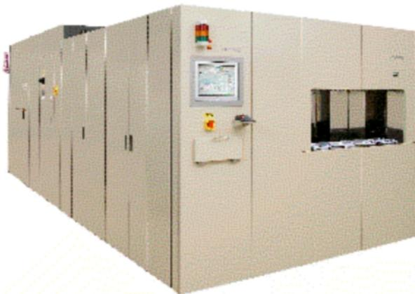
该设备是集成电路制造前工序中的关键设备，离子注入是对半导体表面附近区域进行掺杂的技术，其目的是改变半导体的载流子浓度和导电类型。离子注入与常规热掺杂工艺相比可对注入剂量、注入角度、注入深度、横向扩散等方面进行精确的控制，克服了常规工艺的限制，提高了电路的集成度、开启速度、成品率和寿命，降低了成本和功耗。离子注入机广泛用于掺杂工艺，可以满足浅结、低温和精确控制等要求，已成为集成电路制造工艺中必不可少的关键装备。
