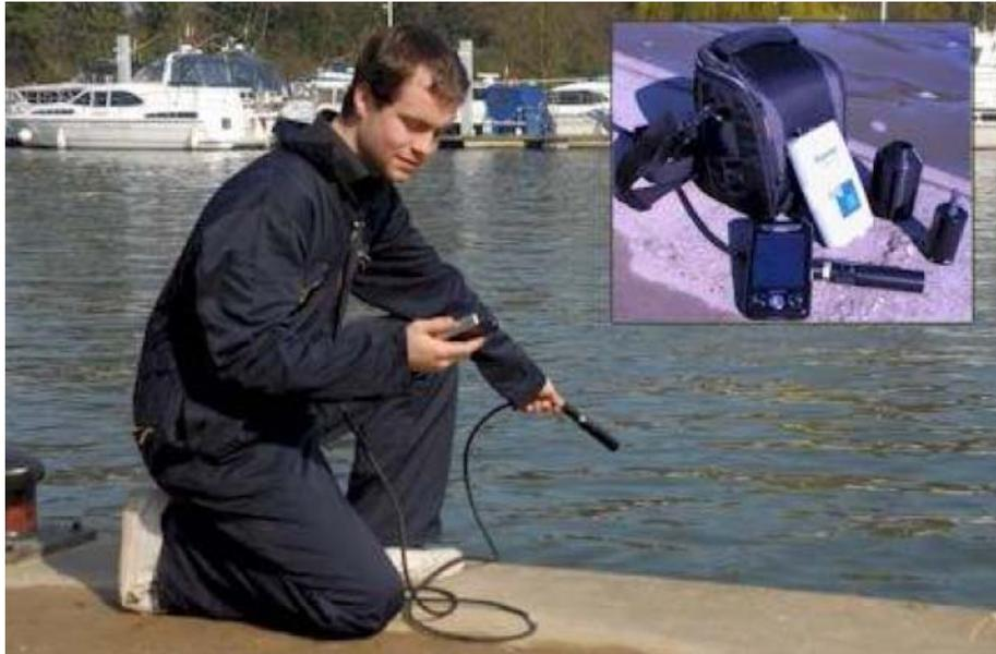
UniLux提供一个用户图形界面（GUI），当直接通过电脑操作时用来画图 and 记录时间数据，并可通过一系列的参数来控制仪器采样。UniLux动态范围也可通过GUI调节LED强度来调整，通过内置参比LED输出而仍然维持工厂校准设置。
