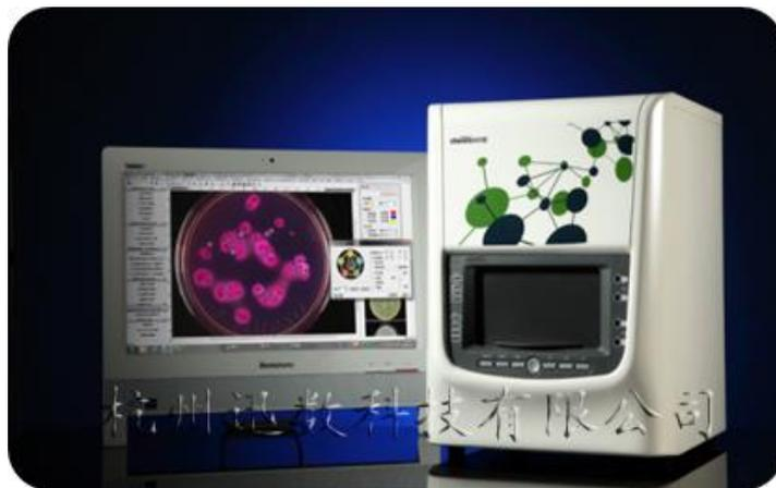
Czone 系列是迅数科技 2013 最新推出的第四代智能抑菌圈测量及菌落计数仪, 专为大中型微生物检测机构设计。全新设计的封闭暗箱、三色 LED 结构光、360 度环绕漫射照明、晶锐悬浮式暗视野、高保真镜头、千万像素摄像头, 为高精度抑菌圈测量、菌落计数提供必要的光影条件。全系列配置了双波长紫外, 满足消毒和荧光菌落激发的需要。
