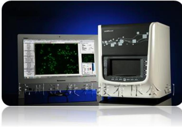
Supcre 系列是迅数科技 2013 全新推出的科研级机型，将活菌计数、抑菌圈测量、菌种筛选三大功能融于一体。三色 LED 环绕照明、色温可调，使得菌落图像更接近自然光成像效果。专业设计的菌种筛选模块可实现：双圈分析、抑菌圈测量、特定菌挑选、不同菌智能识别。全系列配置了双波长紫外，满足消毒、诱变和荧光激发的需求。高端的 Supcre G6R 配置更高品质的镜头和工业相机，菌落、抑菌圈细节展现更为锐利。
