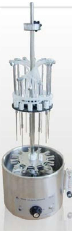
**5**  $100\text{mm}$  不锈钢或玻璃导气钢管。
