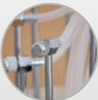
**3** 圆形的分配系统，导气管可自由升降，并配有氮气流量微量调节针型阀。
