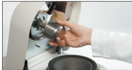
插入研磨槌无需任何工具，快速运行，清洁简便
