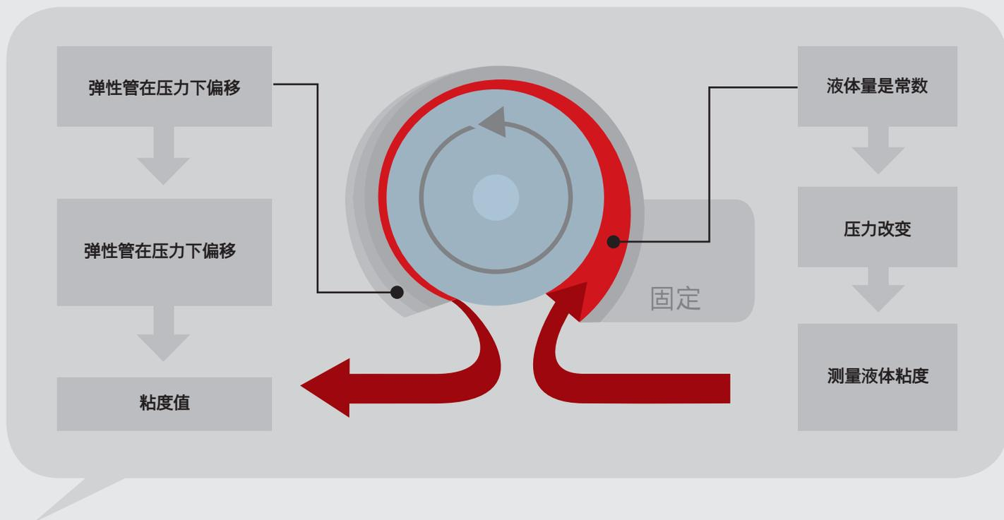
L-Vis510使用了基于测量流体压力的全新原理测量流体粘度。过程液体流入系统，并流过管和转子之间的空隙。空隙越来越小，导致管壁在样品的压力下偏移。电子传感器测量偏移的大小，并用以计算粘度值。一个电子传感器测量偏移的量，并用以计算粘度值。
