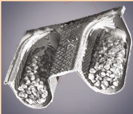
原泡罩包装中的药剂 胶囊的 CT 重构图， 虚拟解剖
