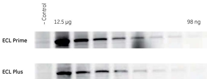
**图8.** 使用ECL prime和ECL plus对IFN $\alpha$ 处理的Hela细胞中的pSTAT3进行免疫印迹检测。与ECL plus相比，ECL prime能产生更高强度的信号，这使得蛋白检测的质量即灵敏度得到改善。对照条带为6.25  $\mu$ g非处理细胞总蛋白。
