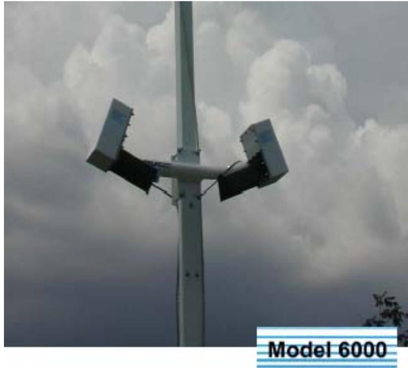
Belfort Model 6000能见度传感器是针对监控6米—80公里范围内的能见度状况而设计的。Model 6000包括模拟和数字输出。模拟输出可选范围：0-1V、0-5V、0-10V和4-20mA。还包括警报输出，警报输出可以按照用户预定的能见度临界值进行警报。两个警报通道是标准的，通过设置合适的临界值，可指示好/中等/差的能见度。RS232或RS422数字输出在300—38,400波特的输出被用来指示实时的能见度和提供诊断信息。
