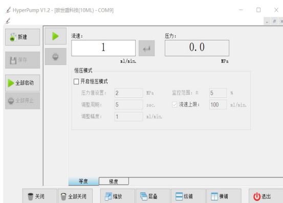
恒压模式泵控制界面
