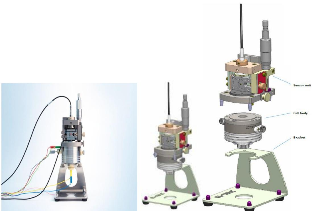
ECD-3-纳米电化学仪器的心脏是一个电化学电池，它是气密对环境氛围。两电极内的硬玻璃，固定在位置分离。上（工作）电极通过一个薄的金属膜的装置，通过它的任何电荷引起的高度变化被发送向传感器/负载单元以上。
