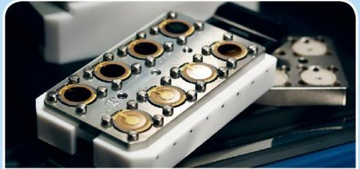
1 在Q-Sense Pro的流动模块内固定传感器（最高可达8个），然后将模块放在仪器测试槽内。
