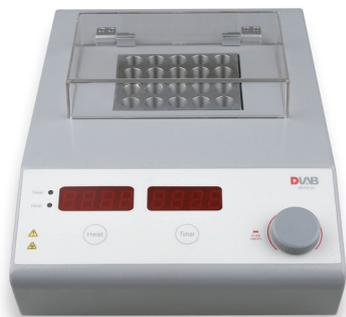
DLAB HB150-S金属浴加热温度可达150℃，提供单模块和双模块两种配置，适用于分子生物学、临床、环境和工业实验室的各种应用。
