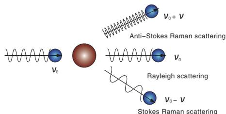
瑞利散射和拉曼散射
