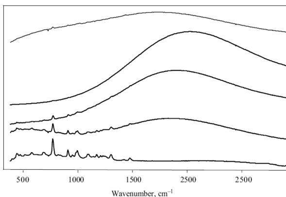
不同荧光背景下，某API和赋形剂拉曼光谱图比较
