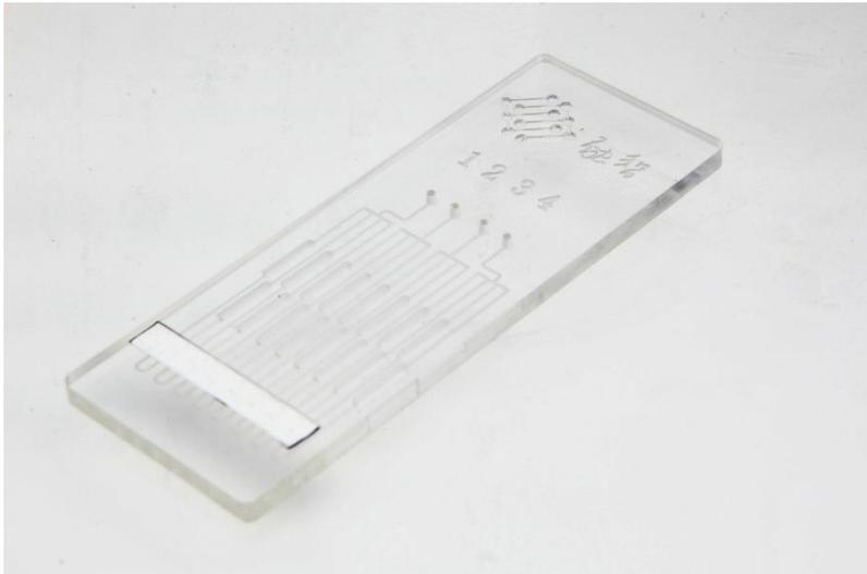
微流控 (Microfluidics) 是指使用微管道处理和操纵微小流体所涉及的多学科交叉的一门技术，具有微型化、集成化等特征。微流控芯片是微流控技术实现的主要平台，也被称为芯片实验室 (Lab on a Chip) 和微全分析系统 ( $\mu$ -Total Analytical System)。其重要特征之一是微尺度环境下具有独特的流体性质，如层流和液滴等。借助这些独特的微流控技术，在生物医学研究中具有巨大的发展潜力和广泛的应用前景。
