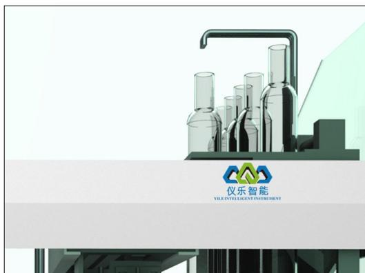
**3** 加硫酸银-硫酸溶液：将烧杯连接到回流装置冷凝管下端，通入冷凝水，从冷凝管上端缓慢加入15ml硫酸银-硫酸溶液，防止低沸点有机物的逸出；磁力搅拌，混匀。
