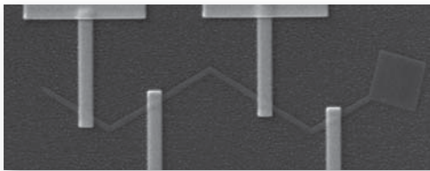
图. FIB加工的宽200nm长16 \mu m的(坡莫合金/Cu/Co)合金纳米线，采用FIB沉积Pt进行电极接触，用于磁畴壁运动研究
