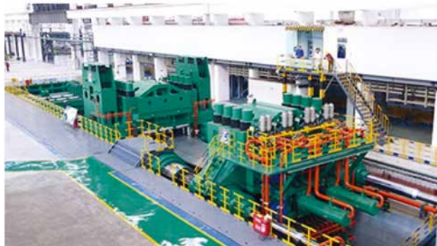
12000吨航空铝合金厚板张力拉伸装备
