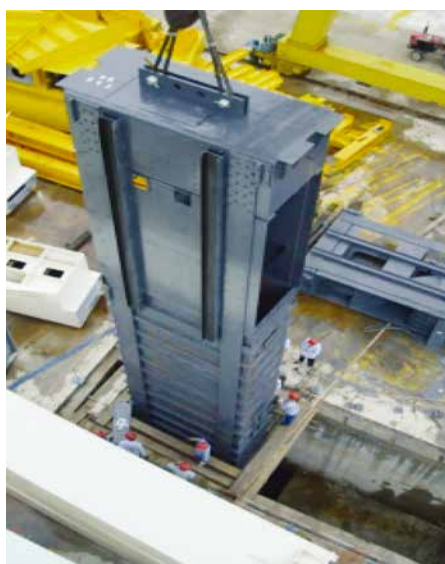
45吨大型提升机箕斗
