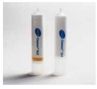
Cleanert® SLE-OD 偶氮染料专用柱,填料为采用特殊工艺处理的硅藻土,具有最大的比表面积和均衡的表面活性,能够提供一个理想的液液分配支撑表面,保证芳香胺类物质的检测灵敏度及稳定性。
