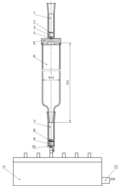
1 玻璃小柱; 2 PTFE 垫片; 3 RP-C<sub>18</sub> 填料; 4 PTFE 垫片; 5 圆盘; 6 样品池; 7 玻璃小柱;
