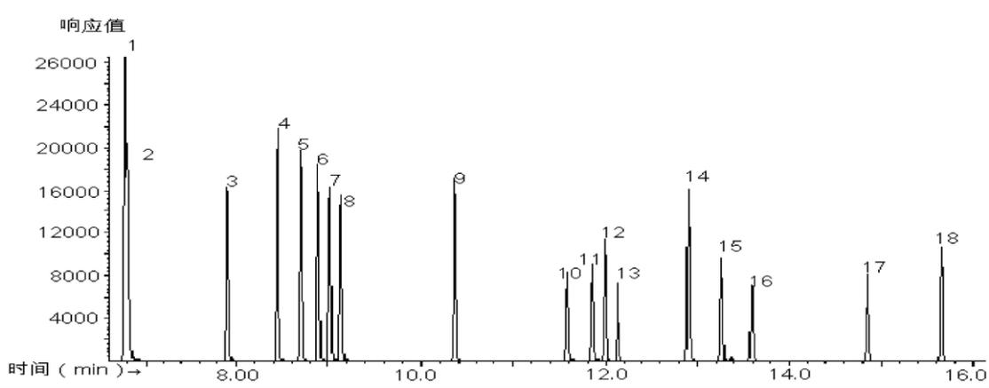
1—硝基苯-d<sub>5</sub>(SS); 2—硝基苯; 3—邻-硝基甲苯; 4—间-硝基甲苯; 5—对-硝基甲苯; 6—间-硝基氯苯; 7—对-硝基氯苯; 8—邻-硝基氯苯; 9—1-溴-2-硝基苯 (IS); 10—对-二硝基苯; 11—间-二硝基苯; 12—2,6-二硝基甲苯; 13—邻-二硝基苯; 14—2,4-二硝基甲苯; 15—2,4-二硝基氯苯; 16—3,4-二硝基甲苯; 17—2,4,6-三硝基甲苯; 18—五氯硝基苯 (SS)
