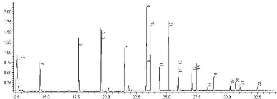
1—苯胺-d<sub>5</sub>; 2—苯胺; 3—1,2-二氯苯-d<sub>4</sub>; 4—2-氯苯胺; 5—3-氯苯胺; 6—4-氯苯胺; 7—4-溴苯胺; 8—2-硝基苯胺; 9—2,4,6-三氯苯胺; 10—3,4-二氯苯胺; 11—3-硝基苯胺; 12—2,4,5-三氯苯胺; 13—4-氯-2-硝基苯胺; 14—4-硝基苯胺; 15—2-氯-4-硝基苯胺; 16—2,6-二氯-4-硝基苯胺; 17—菲-d<sub>10</sub>; 18—2-溴-6-氯-4-硝基苯胺; 19—2-氯-4,6-二硝基苯胺; 20—2,6-二溴-4-硝基苯胺; 21—2,4-二硝基苯胺; 22—2-溴-4,6-二硝基苯胺
