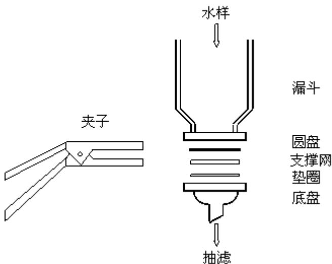
图 2-11-1 固相萃取装置萃取部分示例示意图
