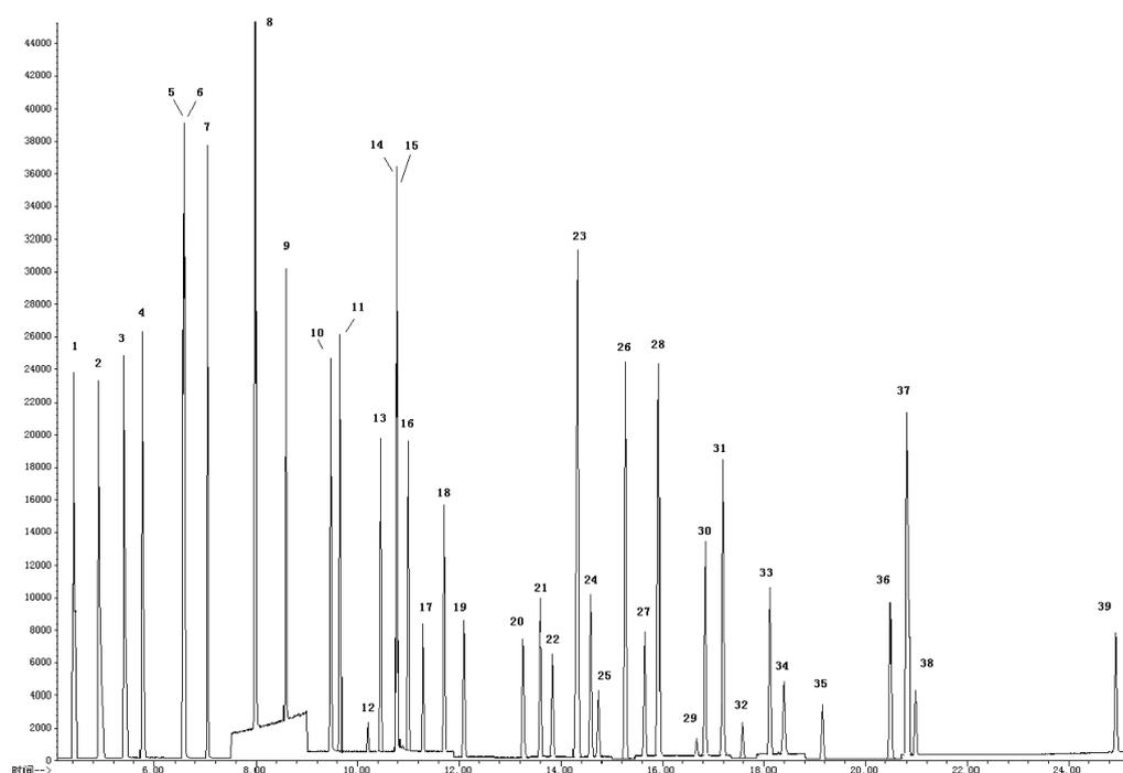
图 2-2-1 有机氯农药和氯苯类化合物 (SIM) 总离子流图
