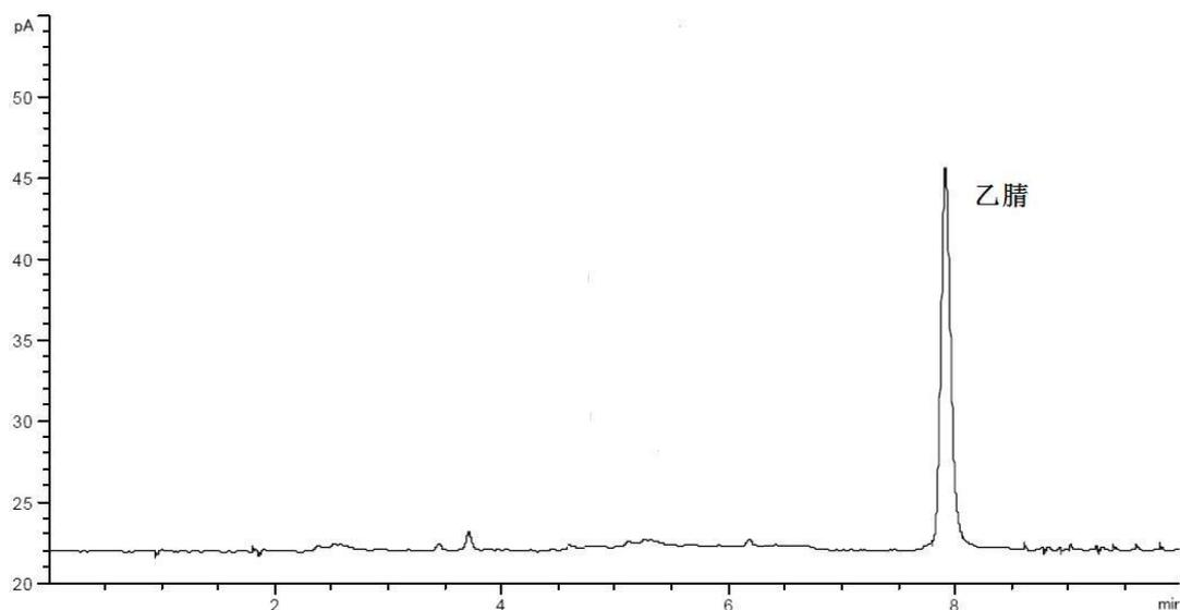
图 2-6-3 乙腈标准色谱图(氢火焰离子化检测器)
