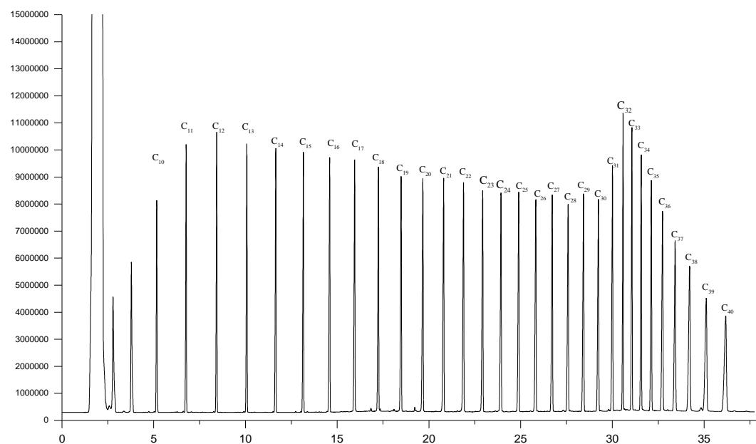
图 2-4-1 C<sub>10</sub>-C<sub>40</sub> 正构烷烃气相色谱图
