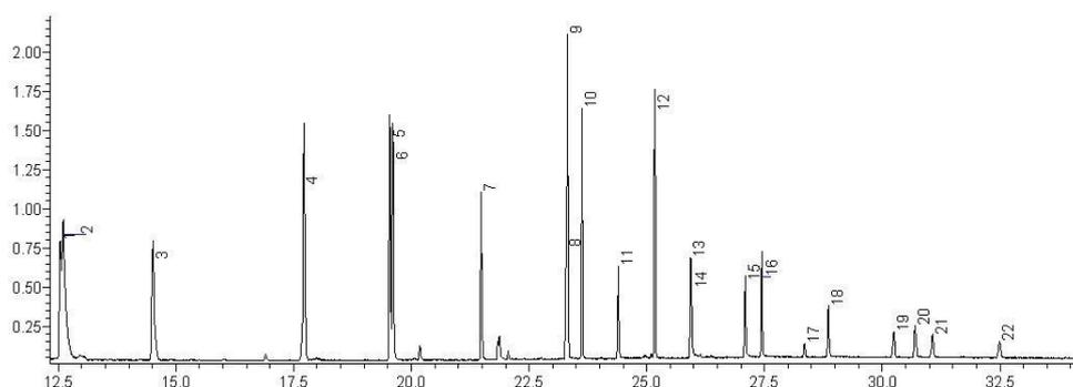
1—苯胺-d<sub>5</sub>；2—苯胺；3—1,2-二氯苯-d<sub>4</sub>；4—2-氯苯胺；5—3-氯苯胺；6—4-氯苯胺；7—4-溴苯胺；8—2-硝基苯胺；9—2,4,6-三氯苯胺；10—3,4-二氯苯胺；11—3-硝基苯胺；12—2,4,5-三氯苯胺；13—4-氯-2-硝基苯胺；14—4-硝基苯胺；15—2-氯-4-硝基苯胺；16—2,6-二氯-4-硝基苯胺；17—菲-d<sub>10</sub>；18—2-溴-6-氯-4-硝基苯胺；19—2-氯-4,6-二硝基苯胺；20—2,6-二溴-4-硝基苯胺；21—2, 4-二硝基苯胺；22—2-溴-4,6-二硝基苯胺
