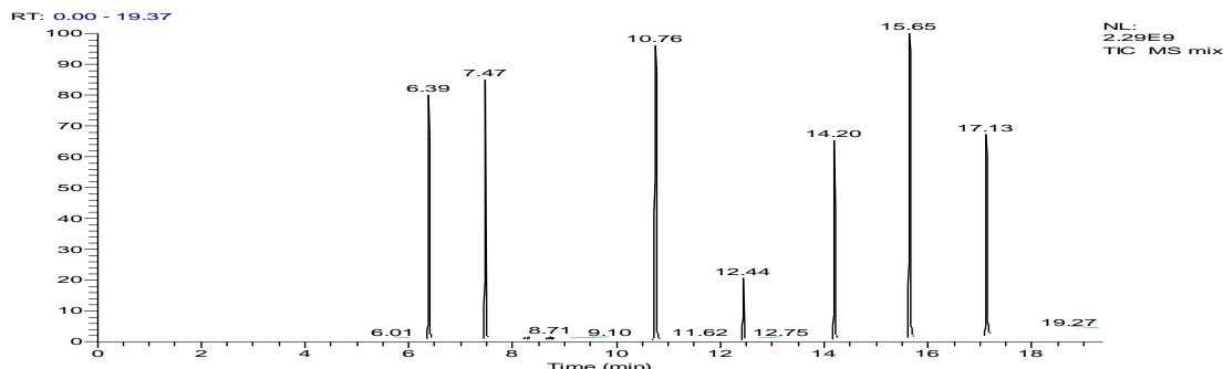
图 2-3-3 邻苯二甲酸酯类化合物总离子流图
